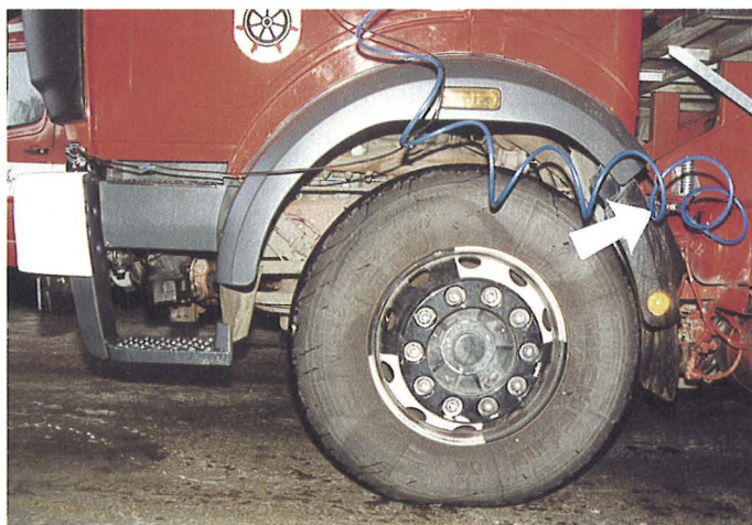
Virheellisesti pysäköityä autoa työntäessä puomitikasauton puskurin pää vääntyi ja paineilmaletku irtosi puskuriin kiinnitetystä takaiskuventtiilistä. Auton korjauksen yhteydessä takaiskuventtiili siirrettiin suojaisaan paikkaan hyttöosan taakse (nuoli).
