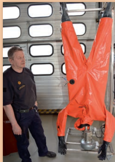
Ammattimies Reijo Kakriainen on toteuttanut kemikaalisuojapuvun kuivaustelineen, johon voidaan johtaa myös kuivattavaa ilmaa.
