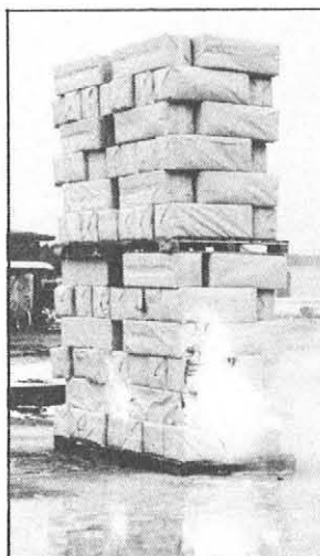
Kuvat 1...3. Munakenttien varastopinon koepolttu. Voimapaperiin pakattujen munakenttien pino sytytettiin yhdellä tulitikulla ja pino oli kauttaaltaan tullessa suunnilleen kahden minuutin kuluttua.
