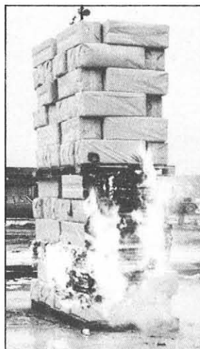
Kuvat 1...3. Munakenttien varastopinon koepolttu. Voimapaperiin pakattujen munakenttien pino sytytettiin yhdellä tulitikulla ja pino oli kauttaaltaan tullessa suunnilleen kahden minuutin kuluttua.
