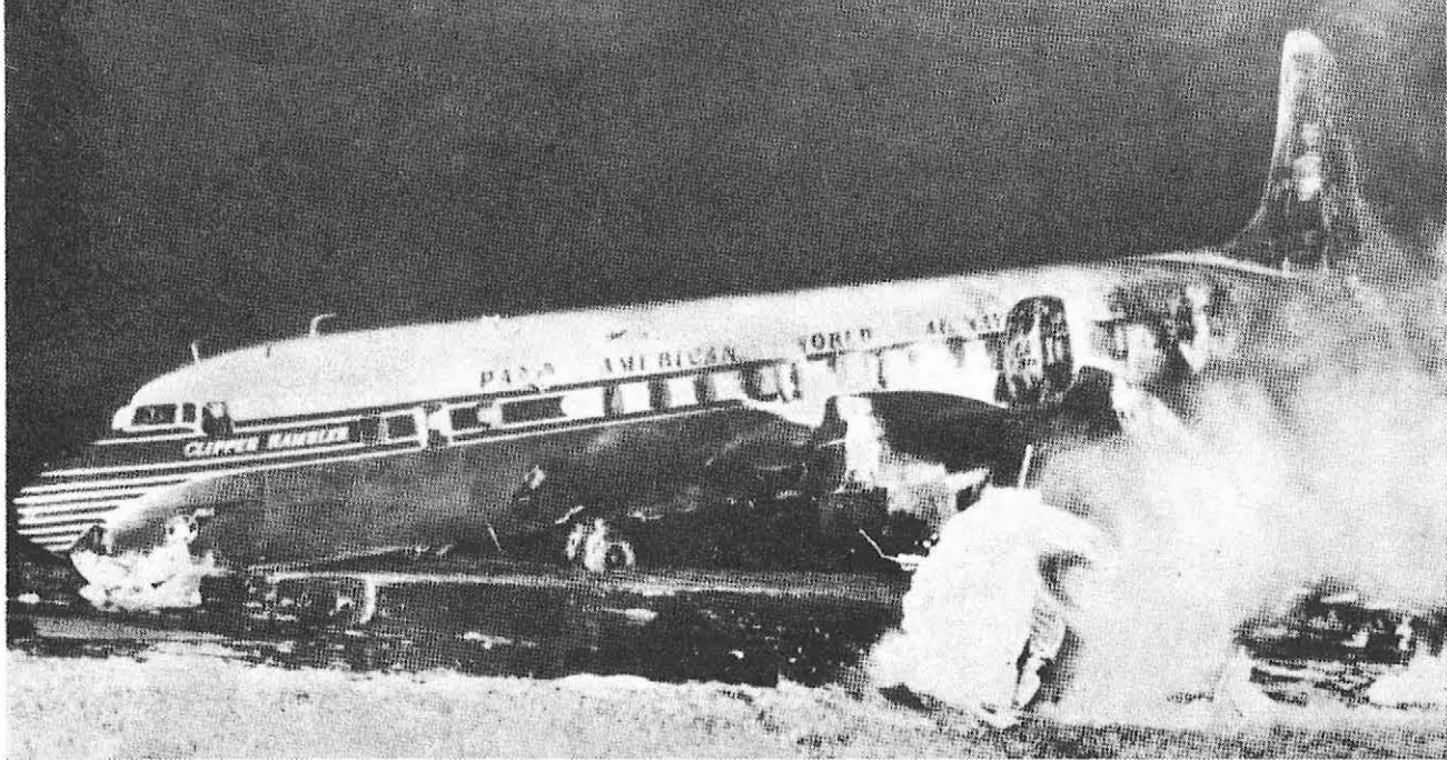
KUVA 1. — Baltimoressa koulutuslennolle startanneen DC-7 koneen nokkapyörä painui sisään, moottorit hajosivat ja syttyivät tuleen. Kaikki koneessa olleet pelastettiin palokuntien ansiosta.
