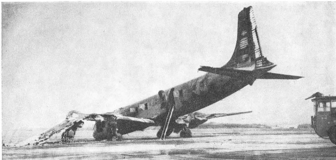
KUVA 2. Vaahto yksin ei pystynyt sammuttamaan tätä tuleen syttynyttä DG-7 konetta. Lisäksi tarvittiin clorbromimetaania.
