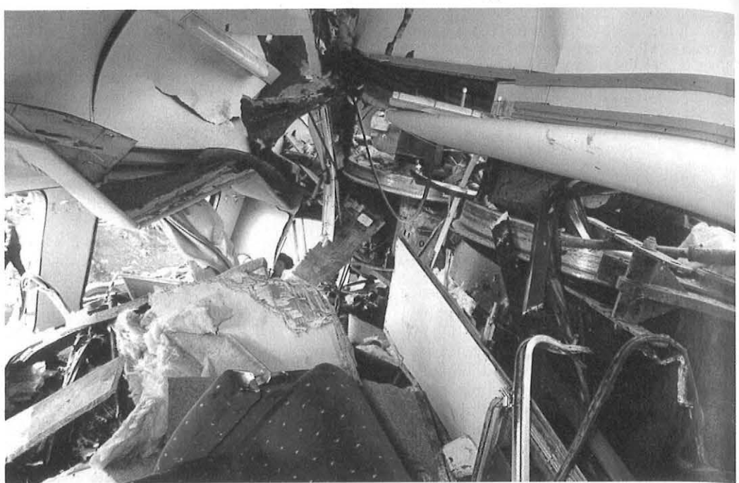
Sisäkuva veturin etuosaan taittuneesta päivävaunusta. Onnettomuudessa pahiten loukkaantuneet ja kuoolleet matkustajat istuivat vaunun tässä osassa. Kuvassa oikealla näkyvät kaatuneen veturin telin pyörät.
