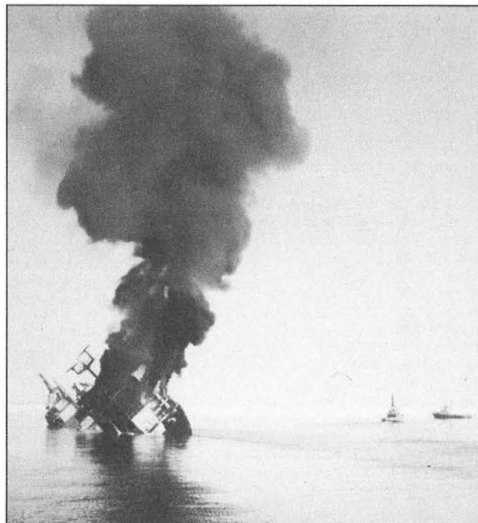
Palo on kiihtynyt polttoainepäiväsäiliön yläosan revetessä.
