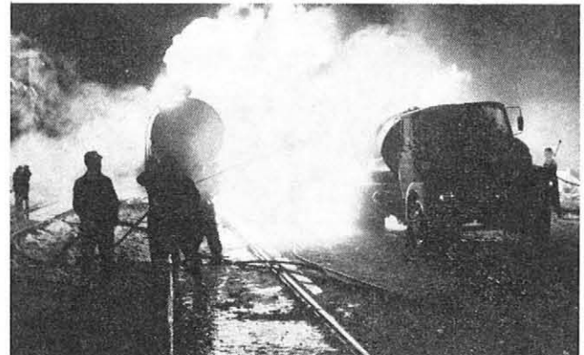
KUVA 6. Säiliöauton vabingot rajoittuivat alta palaneisiin renkaisiin ja peräosastaan palaneisiin asennuksiin ja eristeihin.
