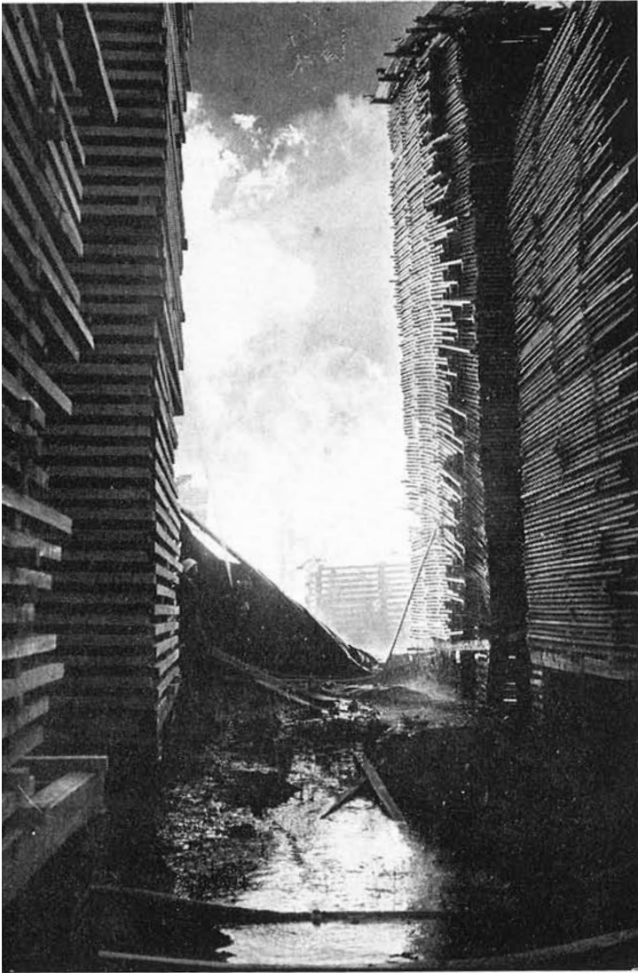
Kuvasta ilmenee kuinka sammutus- ja suojaussuihkujen vesi »läpäisee» kallistetun tapulin. Vesi valuu tapulin läpi lautoja pitkin ja putoaa kaltevien lautojen alapäistä.
